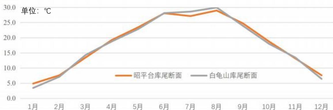
图 5.2.2-1 两个库尾断面月均水温变化曲线
