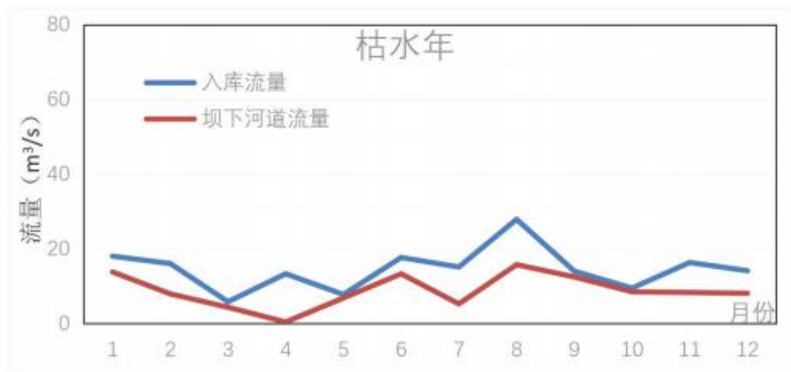
图 5.1.2-2 现状水库入库、坝下河道月均流量
